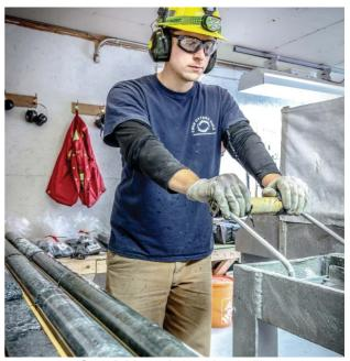
Geotechnician cutting core, Lac des lles
